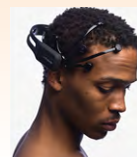
L'individu cible (client, consommateur, créateur...) est équipé d'un casque électroencéphalographique (EEG) et d'un capteur de réponses électrodermales (GSR)
